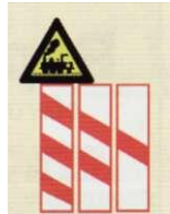
słupki wskaźnikowe przed przejazdami kolejowymi według wzoru niemieckiego
